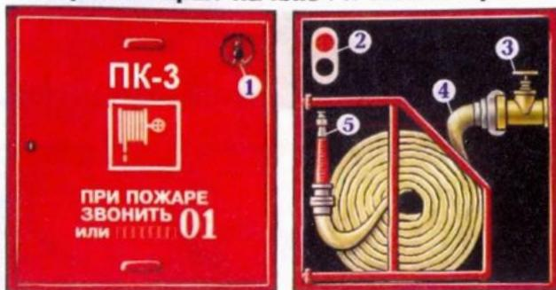
ПРЕДНАЗНАЧЕН для тушения пожаров и загораний веществ и материалов, кроме электроустановок под напряжением
